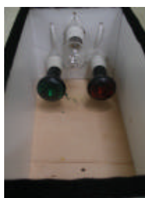
Figura 5: Caixa para ambiente de luz monocromática
