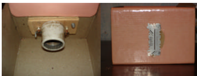
Figura 1: Caixa que produz um feixe de luz colimado
